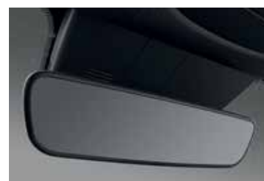
Салонное зеркало заднего вида с автоматическим затемнением (ECM)
