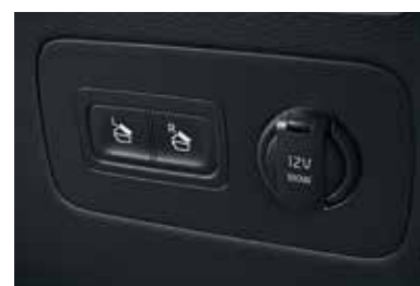
Кнопка складывания сидений 2-го ряда из багажника и дополнительная розетка
