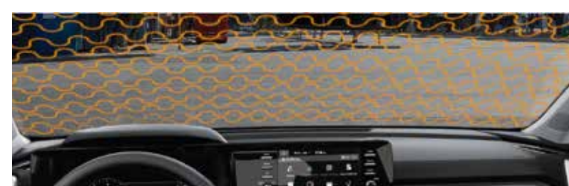
Электрообогрев лобового стекла и форсунок стеклоомывателя
